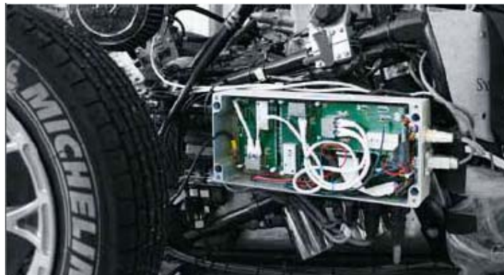
POWERLINK 一个主和两个从站确保了在汽车内部的实时通信
